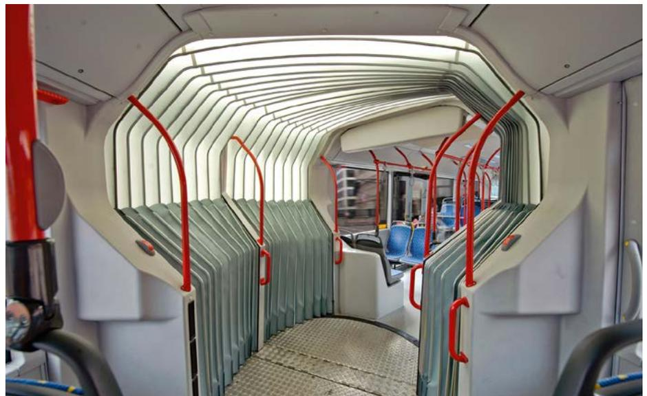
Transluzente Faltenbälge lassen das Sonnenlicht in den Gelenkbereich (Bild © HÜBNER GmbH & Co. KG)
