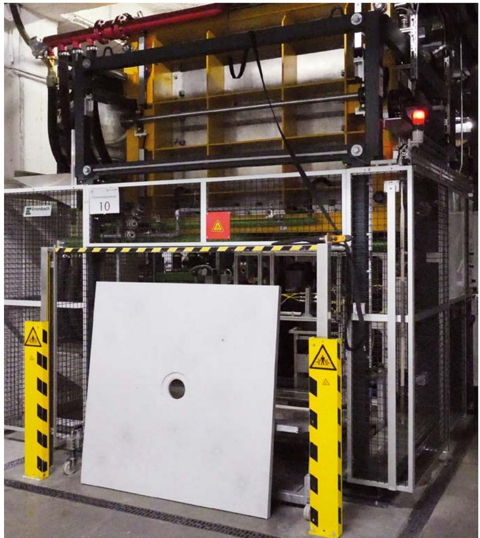
Formteilautomat mit davorstehender Halbfertigware eines bodengleichen Duschsystems mit einer Größe von 150 x 150 cm
