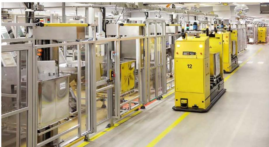
In der Produktion: Automatische Materialversorgung per Fahrerlosem Transportsystem.
