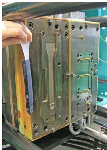
Werkzeug zur Herstellung von Thermoplast-Silikon-Komponenten (Bild © (wd))
