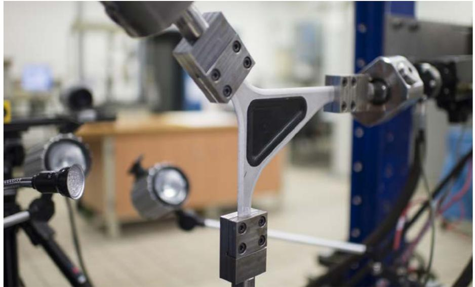
Hybridbauteil mit abdichtender Kunststoffkomponente (Bild © Universität Kassel)
